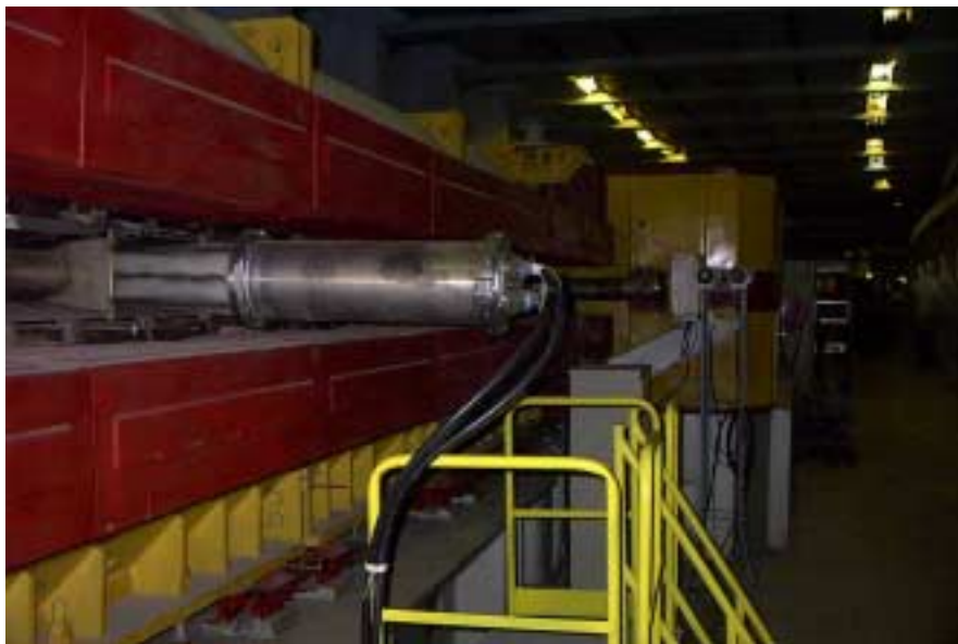
. Станция кристаллических дефлекторов, смонтированная на ускорителе У-70.
