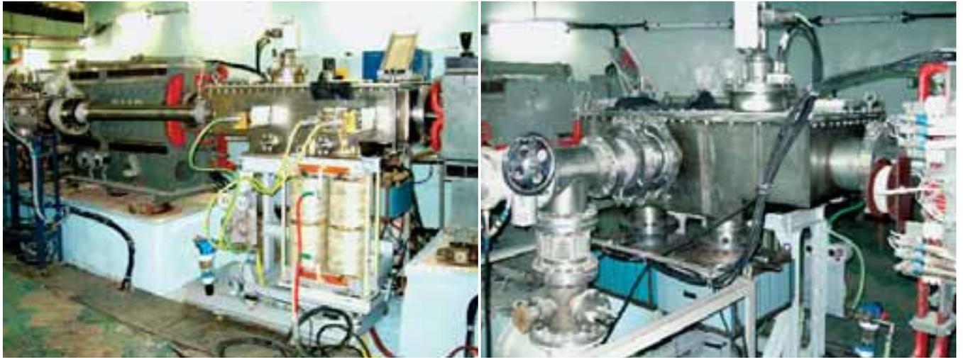
Рис. 12. Септум-магнит СМ (слева) и ударный магнит УБМ (справа), установленные в периоде №9 магнитной системы У-1,5.
