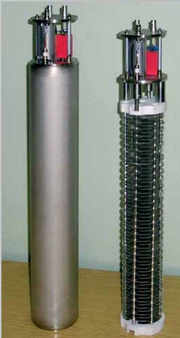
Мониторы потерь пучка представляют собой ионизационные камеры, измеряющие интегральный поток излучения. Камеры помещены в цилиндр из нержавеющей стали. Каждая камера содержит 61 алюминиевый диск толщиной 0,5 мм и заполнена газообразным азотом. Основное требование к мониторам – длительная и надёжная работа в сложных радиационных условиях (суммарная поглощенная доза до  $2 \cdot 10^8$  Гр за 20 лет работы).
