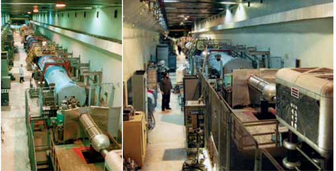
Рис. 7. Ускоритель И-100, вид со стороны электростатического инжектора (слева). Высоковольтная платформа на изолирующих колоннах, присоединенная к импульсному высоковольтному трансформатору ИТ800 (справа).
