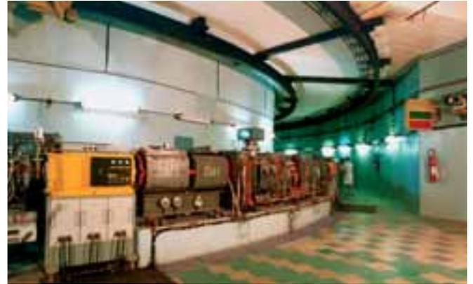
Рис. 4. Протонный синхротрон – бустер У-1,5.
