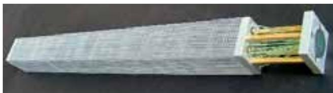
Рис. 2. Модуль «шашлыка» со спиральными волокнами.
